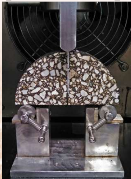
Изгиб полуцилиндров (SCB)
