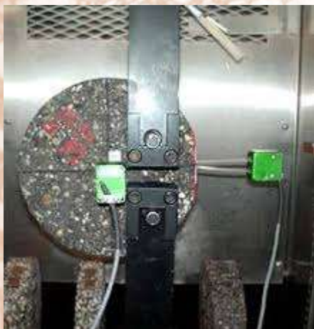
Растяжение уплотненных образцов-дисков (DCT)
